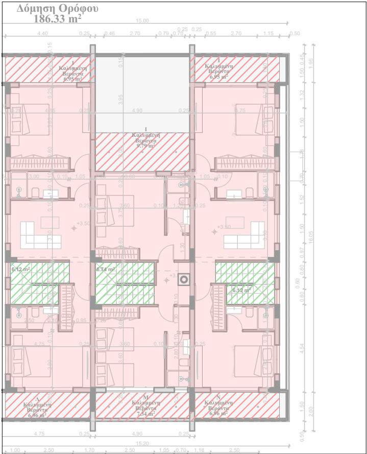
1. Εμβαδομετρήσεις-Ορόφου Σ. Δόμησης 1:200
